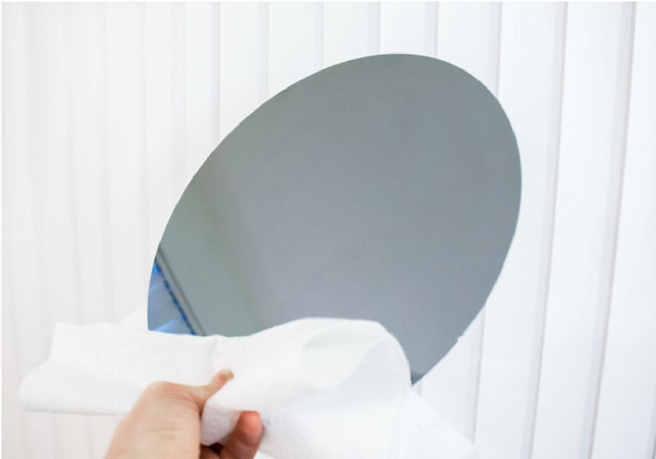
Что получится, если использовать его в качестве светофильтра для цифровой камеры с удалённым внутренним ИК-фильтром? Приёмник — фактически кремний, 15 микрон. И фильтр — кремний. Тот же материал, только толще, 700 микрон. В качестве «сложности» выступает длина волны света. Теория предсказывает, что максимум чувствительности такой системы будет приходиться на ту длину волны, при которой входной фильтр пропускает 37% излучения. Смотрим на график прозрачности кремния от длины волны (с [20]).
